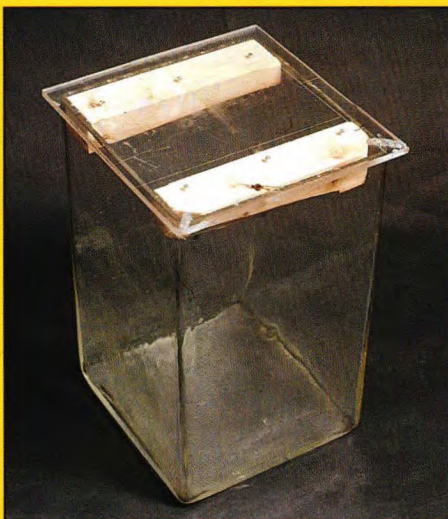
Afb. 3. Uiteraard moet de bak ook een deksel hebben. Hiervoor is een plaatje plexiglas te gebruiken. Liever geen gewoon glas, want daarin is moeilijk te boren. De buitenmaten van het plexiglas zijn iets ruimer dan die van de bak. We zagen twee blokjes hout af en schroeven die vast op het deksel. Daaraan voorafgaand moeten we nauwkeurig hebben afgemeten waar de blokjes moeten komen. Met passen en meten wordt de meeste tijd versleten...
